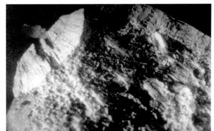
Figuras 18: Detalle en color claro del avance de la fisura por fatiga, mostrando el aspecto de abanico
