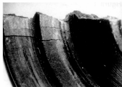
Figura 3b: Detalle de una pieza fracturada
