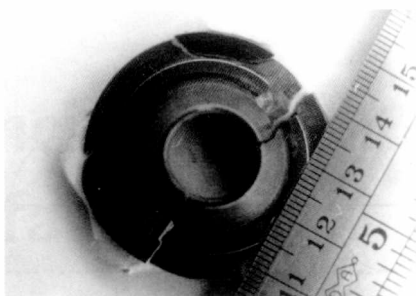
Figuras 3a: Platillo de válvula reconstruido
