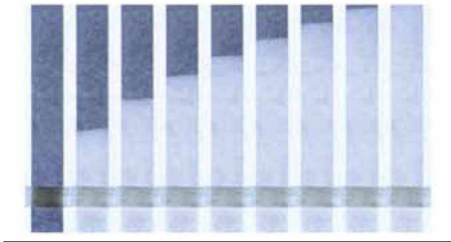
Figura 3: Avance del frente a lo largo del tiempo. La imagen corresponde a un montaje, en el que cada tira de papel de izquierda a derecha corresponde a un tiempo posterior a la anterior.
