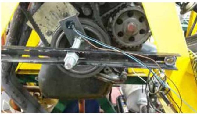
Figura 4. Montaje del sensor de referencia angular.
