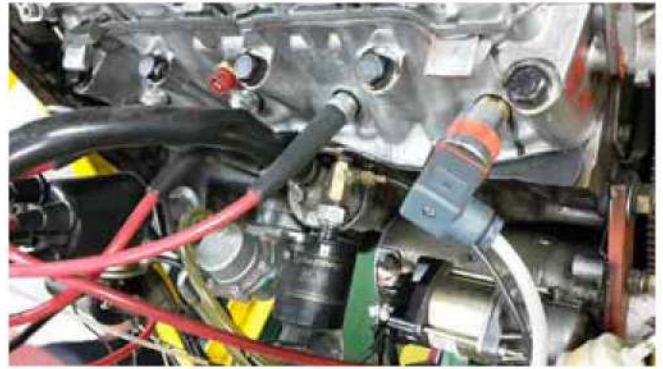
Figura 5. Montaje del sensor de presión en el cil. 4.
