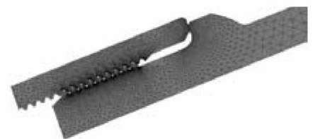
Figura 6: Malla de Elementos Finitos.
