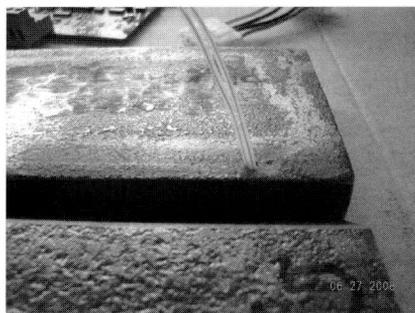
Figura 8: Fotografía de detalle mostrando la inserción de una termocupla en una de las partes del cupón a soldar.
