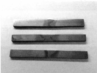
Figura 13: Probetas metalográficas de ADI, soldadas con diferentes electrodos y energía.
