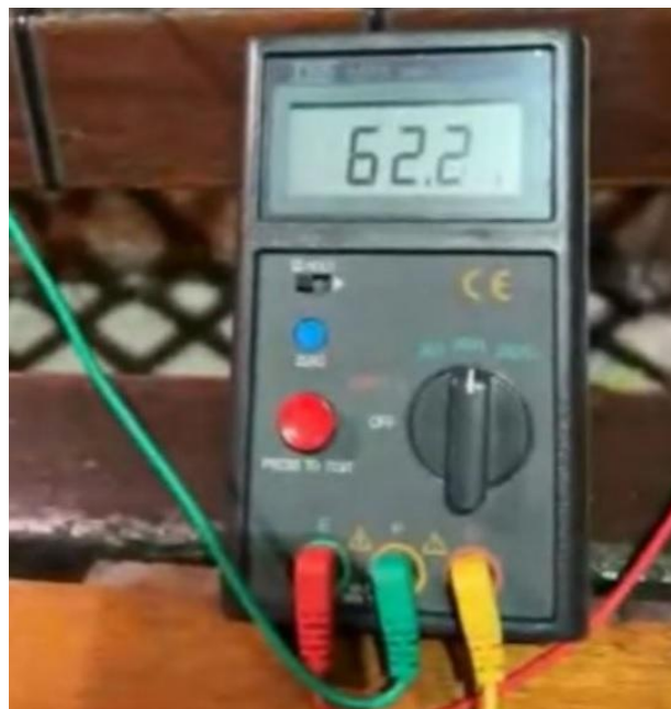
Figura 6: Extracto de captura de pantalla compartida con detalle del telurímetro durante una medición de puesta a tierra.
