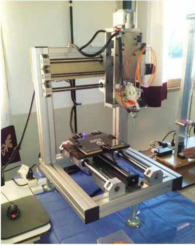
Figura 6: Impresora 3D terminada.
