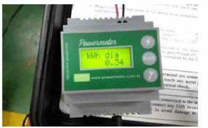
Figura 10. Registro de la energía consumida en una hora.
