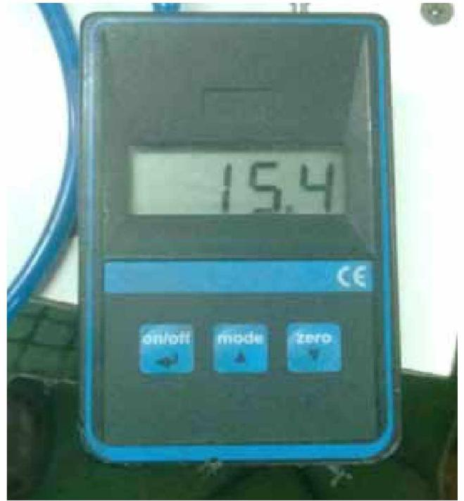
Figura 8. Medición de presión en el conducto.
